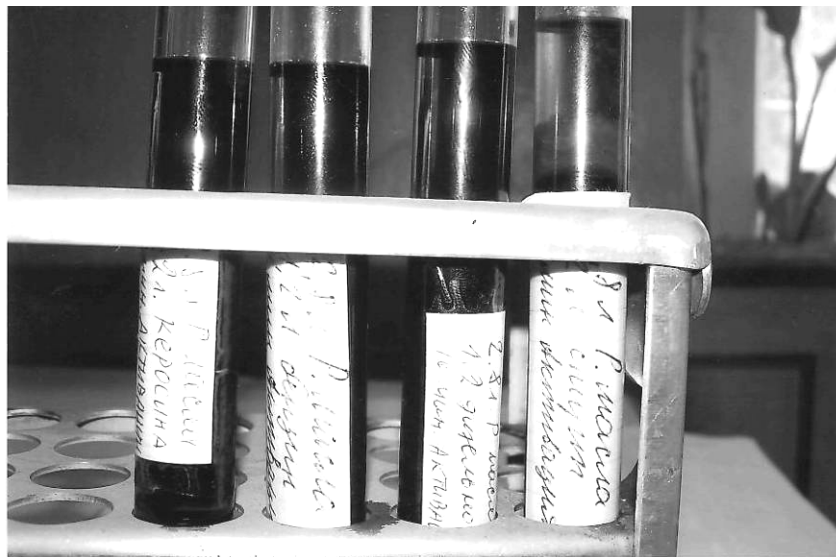
Рис. 4. Образцы топливных смесей после 3-месячной выдержки
